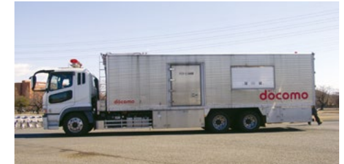
通信ビル用大型移動電源車
