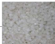
海底ケーブル外皮の高純度 ポリエチレンを完全分離・ チップ化し、高値売却可能に
