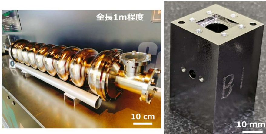
加速器用の超伝導空洞共振器（左）と量子技術用の超伝導空洞共振器（右）
