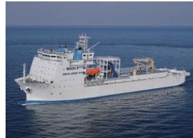
海底ケーブル敷設船「きずな」（総トン数8,598トン）
