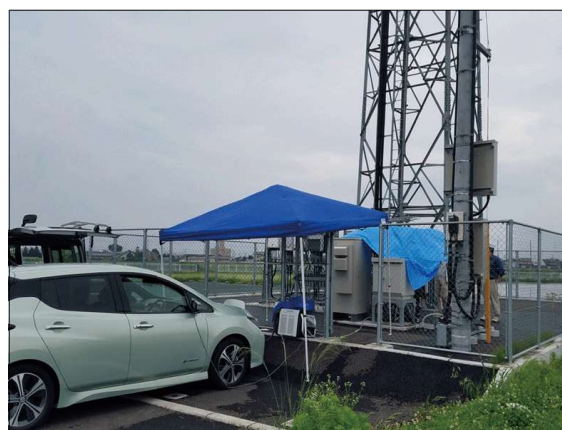
図表1-5-47 ▶ 電気自動車から基地局への電源供給実証実験
