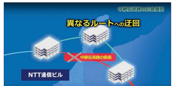
図表1-5-26 ▶能登半島地震：中継伝送路の応急復旧
