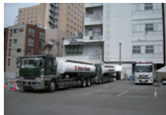
移動電源車とタンクローリーによる電源救済
